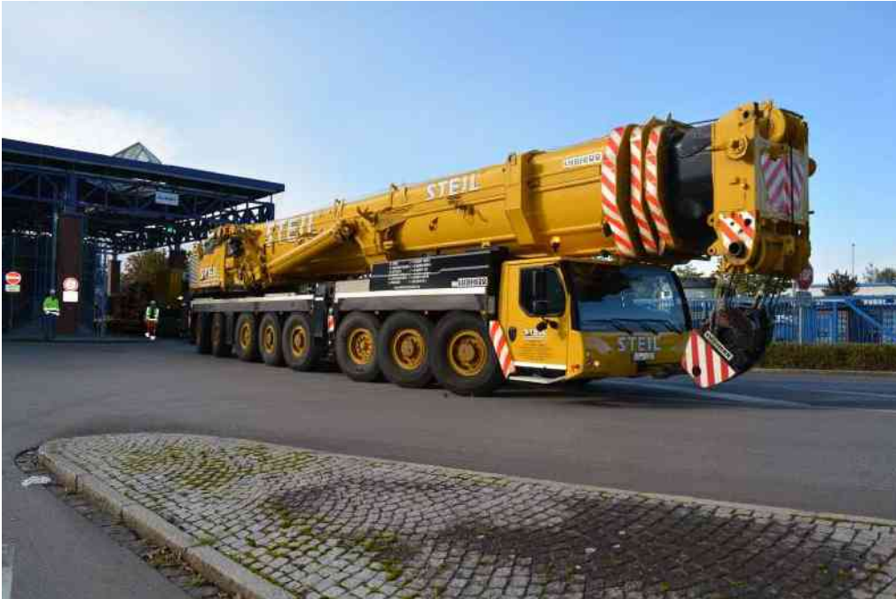
Liebherr-Kran mit einem Gewicht von 96 Tonnen und 8 Achsen für den Aus- und Einhub der Kranteile
